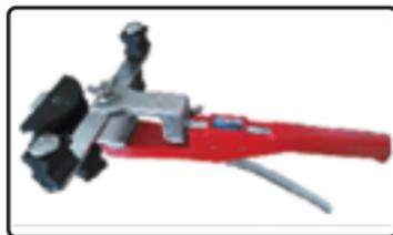
**3** Prepare antes de dobrar colocando um tubo, levante o dobrador e puxe a alavanca de sustentação da barra universal com haste dentada, que retrai-se sob o efeito da gravidade. Vire as peças deslizantes com encaixes do tamanho correto e coloque de frente para a encaixe anterior. Em seguida, coloque o tubo entre as peças anteriores e as deslizantes. (figura)
