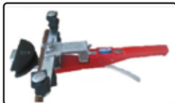
**4** Empurre a alavanca de alimentação repetidamente, empurre a alavanca de alimentação repetidamente até que o tubo seja dobrado em um determinado ângulo necessário.
